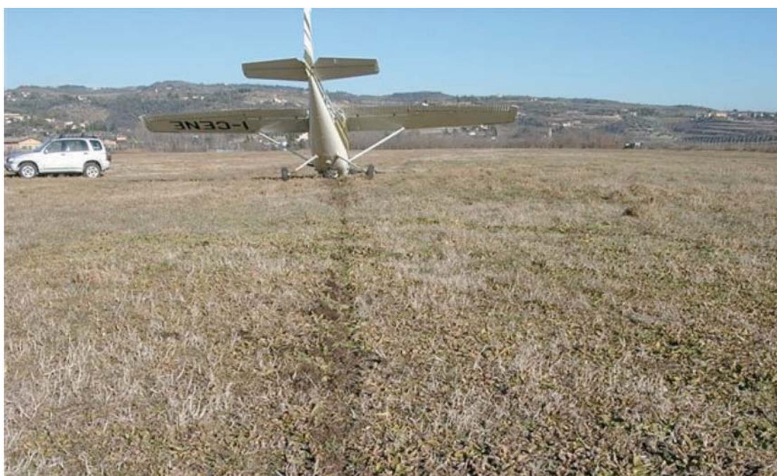
Strisciata sul terreno erboso provocata dal cedimento del carrello anteriore.
