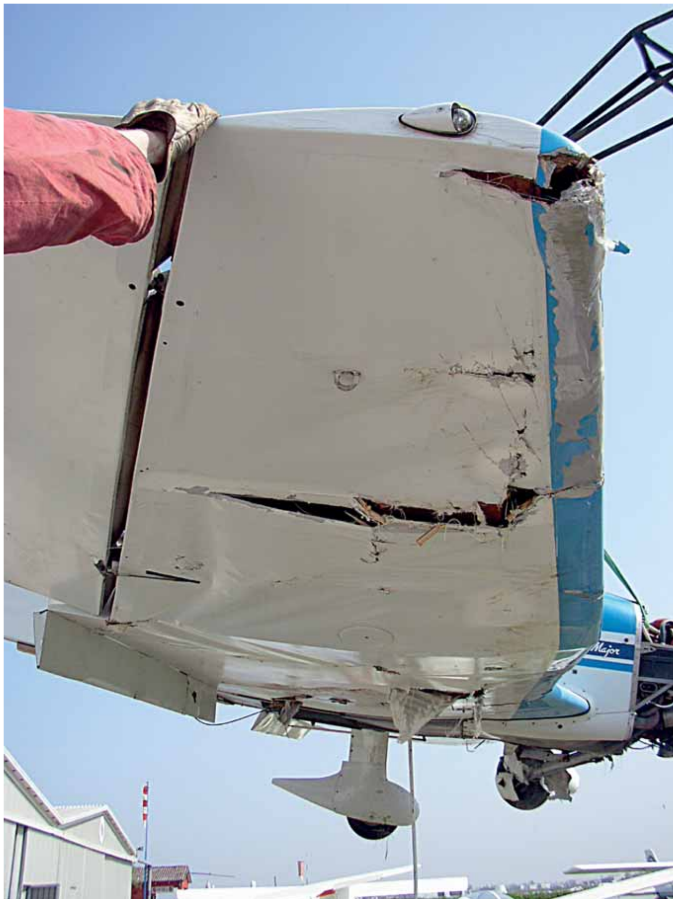
L'aeromobile durante la rimozione; sono visibili i danni a carico della struttura.
