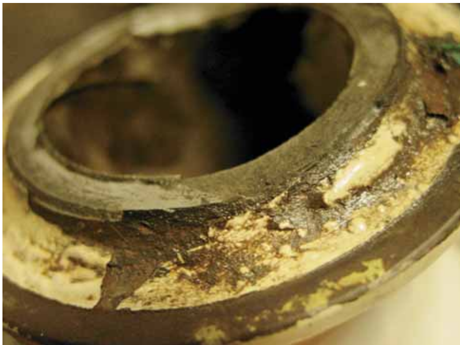
Superficie esterna assale: si noti l'estesa corrosione.
