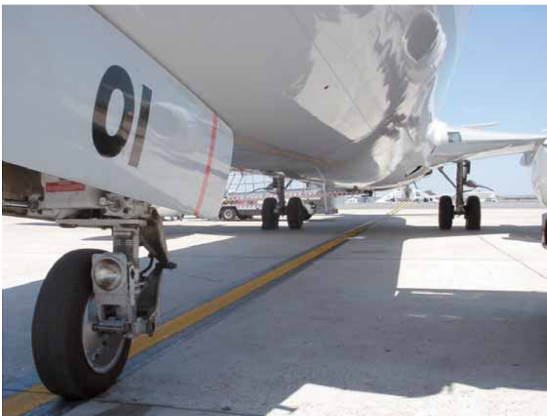
Carrello anteriore aeromobile EI-COI con solo una ruota.
