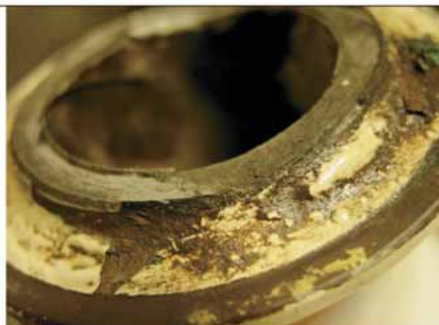
Foto n. 5: estesa corrosione a carico della superficie esterna dell'assale.
