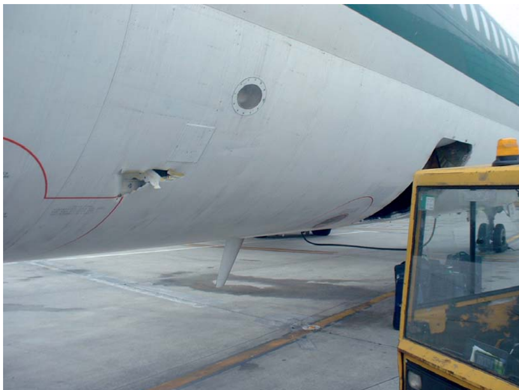
Danni alla fusoliera di un aeromobile arrecati da un mezzo di rampa.
