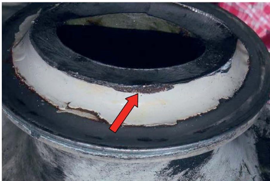
Vista dell'assale con indicazione della zona con presenza di corrosione.
