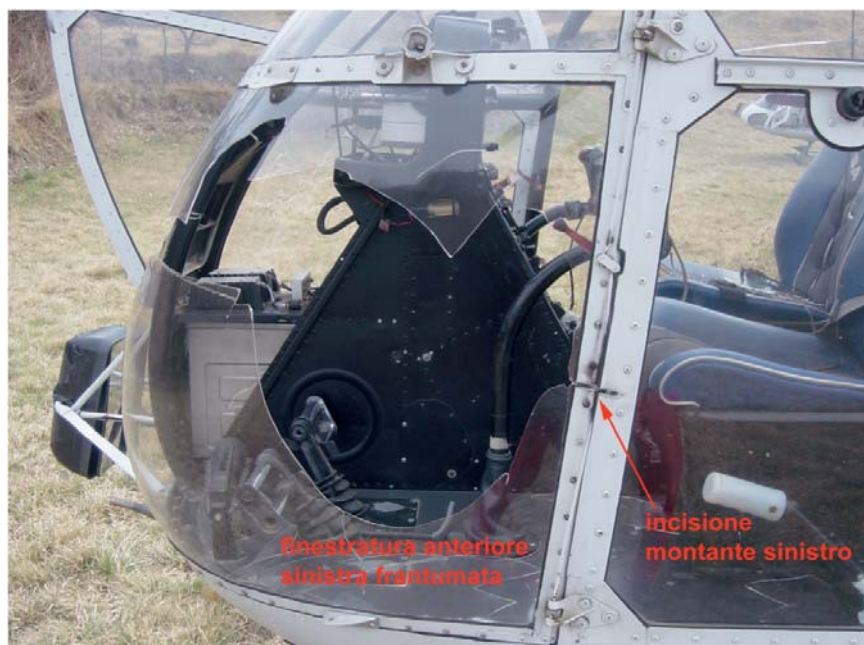
Parte anteriore sinistra elicottero danneggiata dalla collisione contro un cavo metallico.
