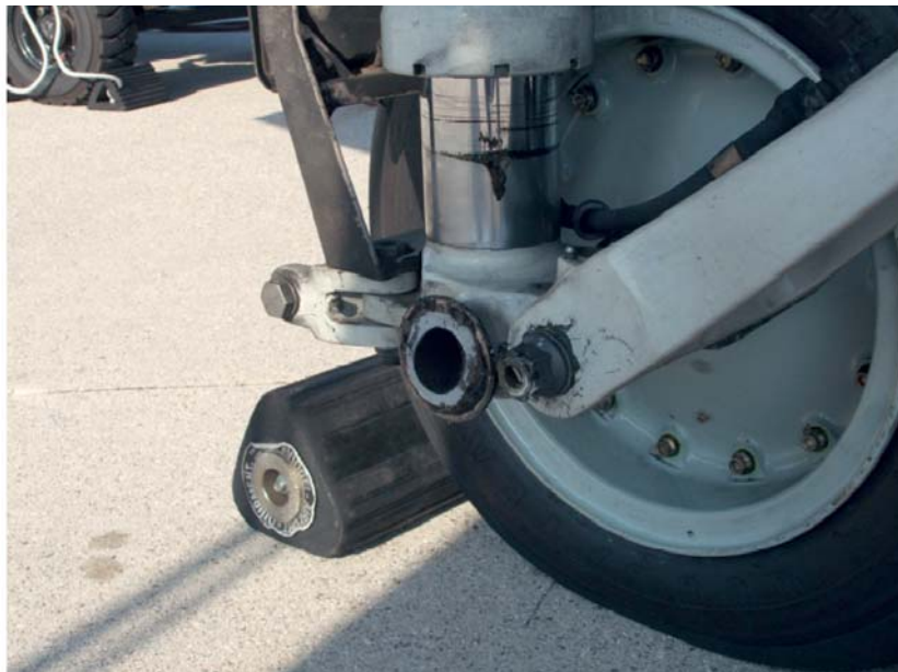
Particolare assale del ruotino anteriore B737.
