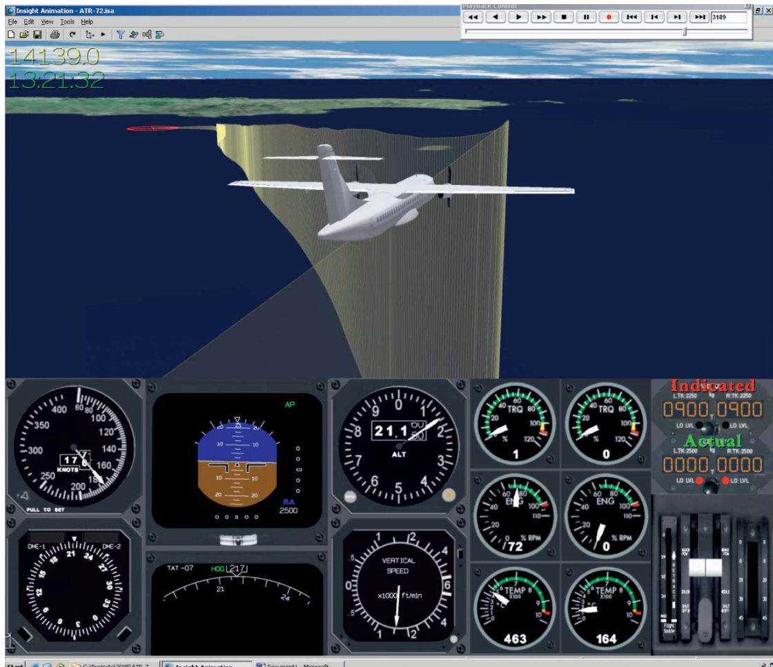
Ricostruzione animata con dati di volo del FDR: l'aeromobile nella fase di discesa, con entrambi i motori spenti.
