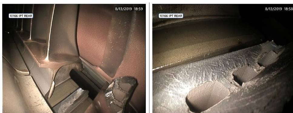
Foto 1: superfici di rottura delle palette IPT.
