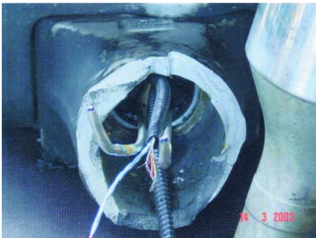
Particolare sezione rottura della swinging lever.
