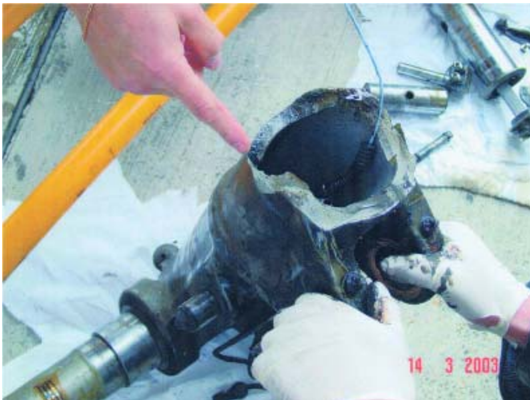
Swinging lever con assale ruote. Particolare sezione rottura con indicazione del punto impatto al suolo.
