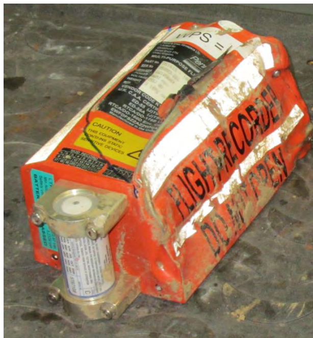
Curtiss&Wright MPFR, in condizioni di elevato danneggiamento, decodificato presso i laboratori dell'ANSV.
