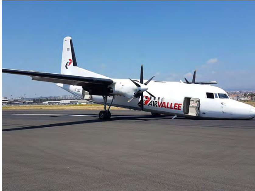
Il Fokker 27 MK050 marche SE-LEZ ripreso dopo l'atterraggio senza il carrello anteriore.
