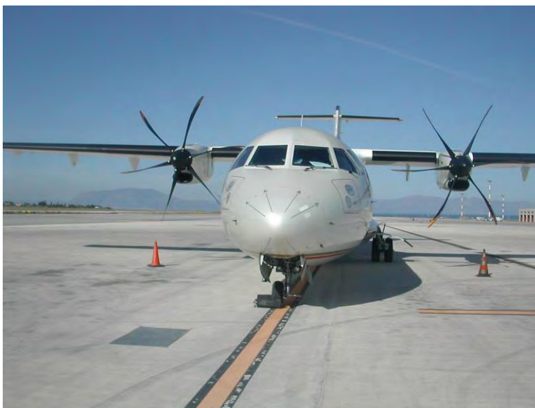
Vista anteriore dell'HB-ACC, in cui si nota l'assenza di una delle due ruote del carrello anteriore.
