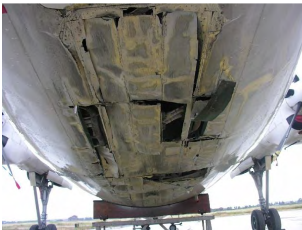
Danni alla parte inferiore della fusoliera.
