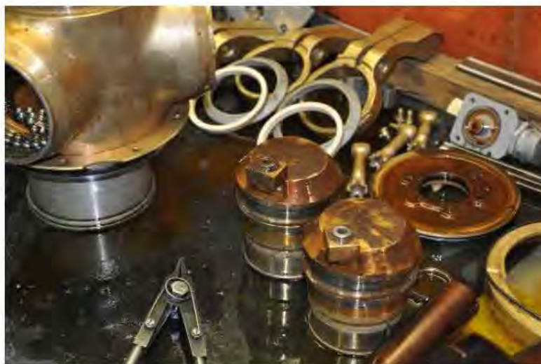
Foto 8: lo smontaggio del regolatore passo dell'elica ha evidenziato olio con presenza di sedimenti metallici.
