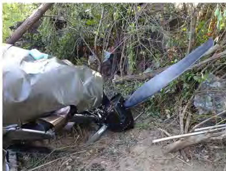
Foto 2: l'elica con danni compatibili con un regime di rotazione nullo.
