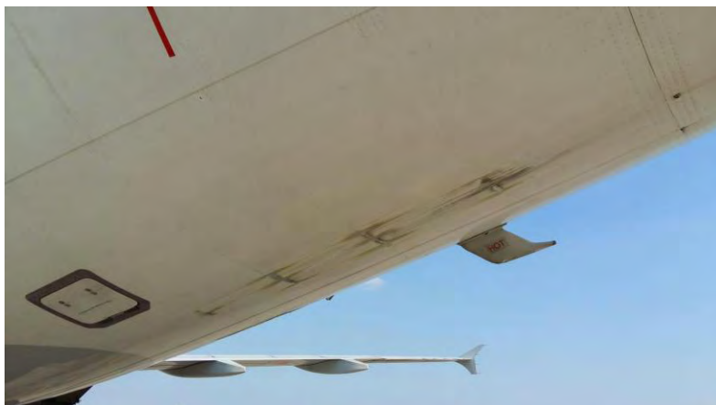
Particolare dei danni subiti dall'aeromobile A320 marche EI-DTB a seguito del tail strike .
