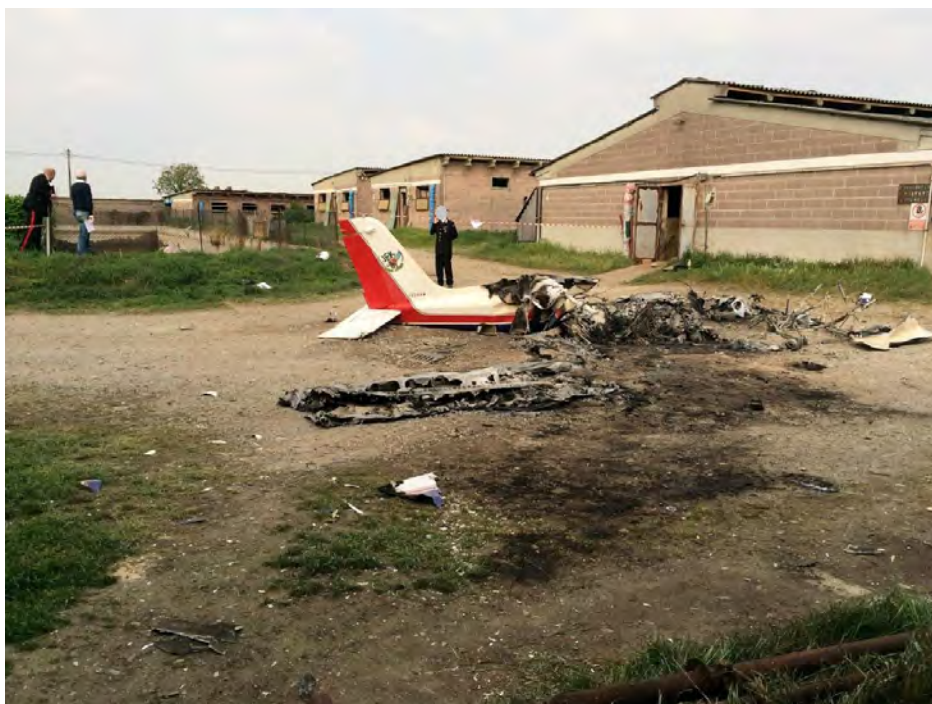
Il relitto del Tecnam P92 ES marche I-7020 distrutto dall'incendio post incidente.
