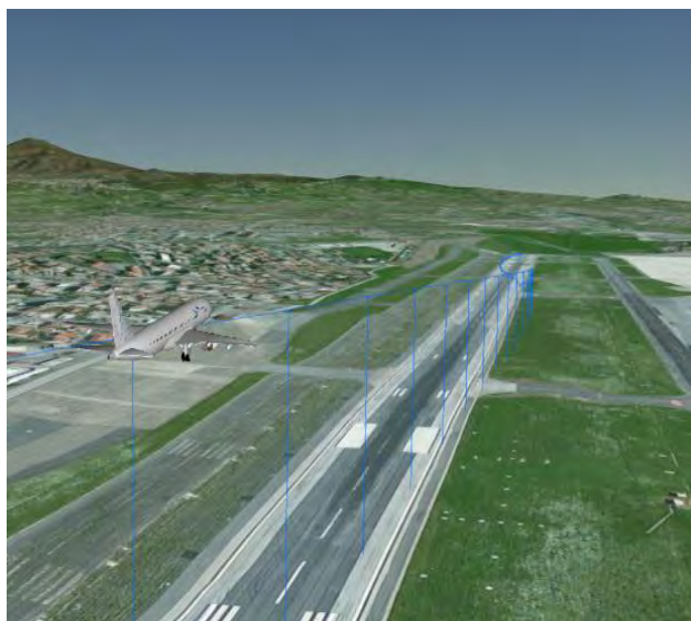
Rappresentazione grafica 3D prodotta mediante parametri FDR.
