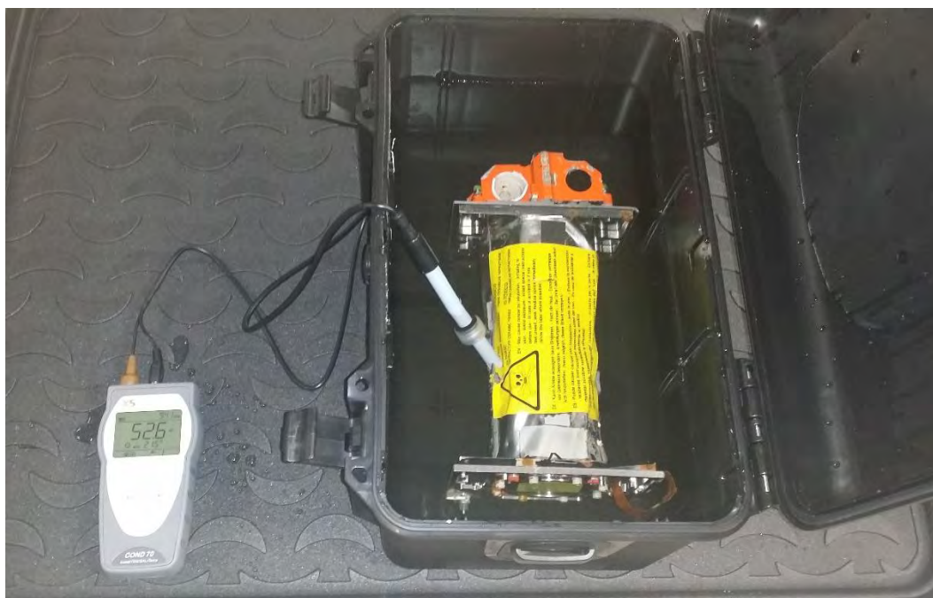
Attività di preservazione del registratore di volo dell'Eurofighter 2000 svolta presso l'ANSV.
