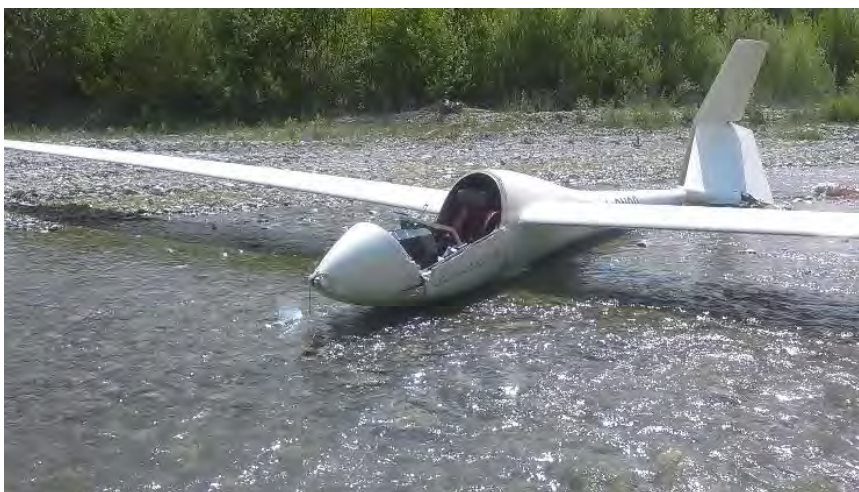
Esempio di atterraggio fuori campo (anno 2017) con danni strutturali all'aliante.
