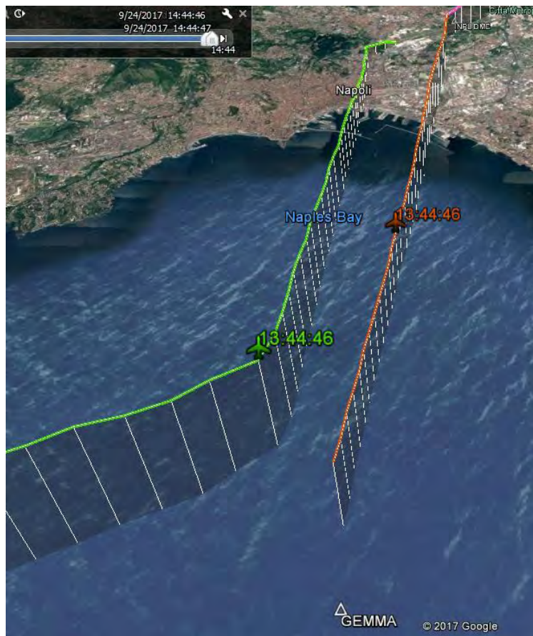
Relazione fra il volo YYY in ICP RWY 24 (traccia verde) e il volo XXX (traccia arancione) in mancato avvicinamento ILS Z RWY 24.
