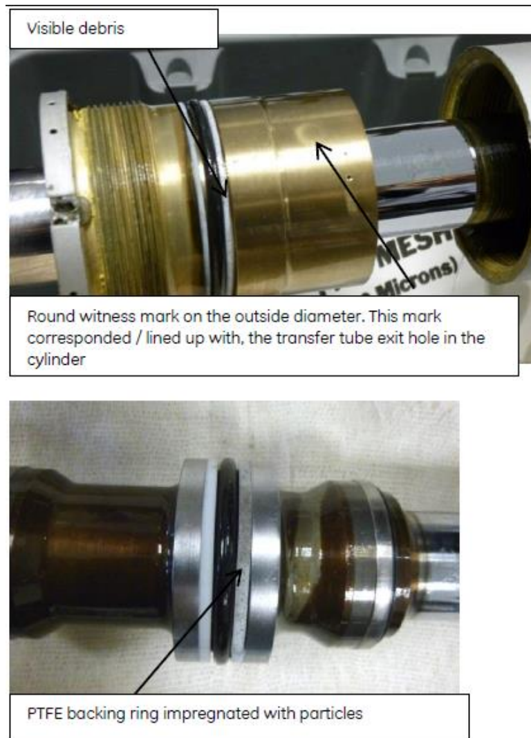
Foto 23: segni da contaminazione dell'olio rinvenuti sull'attuatore sinistro.
