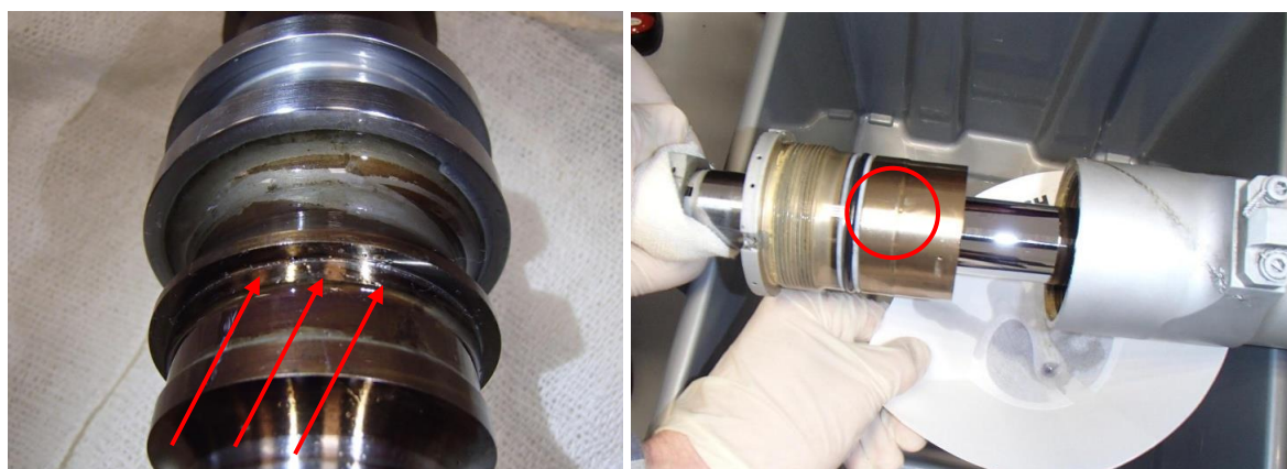
Foto 25: contaminazione trovata nel "LH MLG door actuator".
