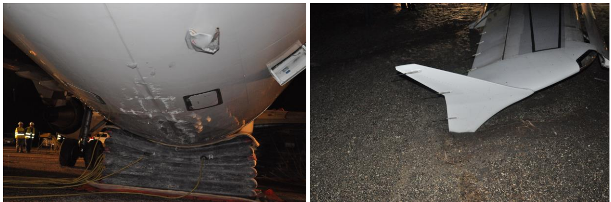
Foto 3: danneggiamenti fusoliera e semiala destra.
