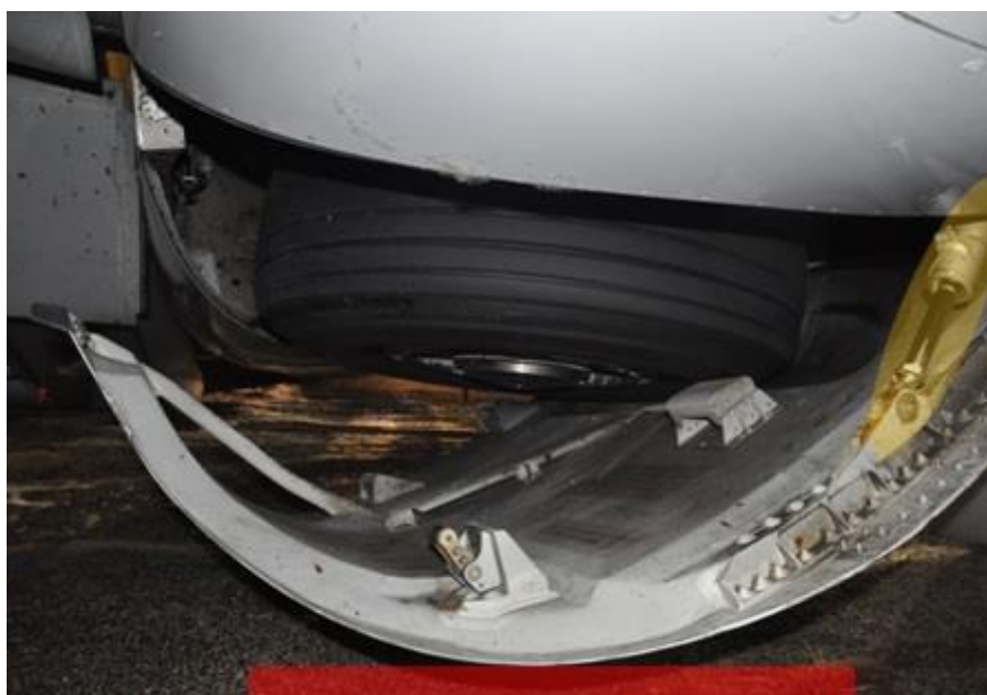
Foto 10: posizione del carrello principale destro e relativo portellone.
