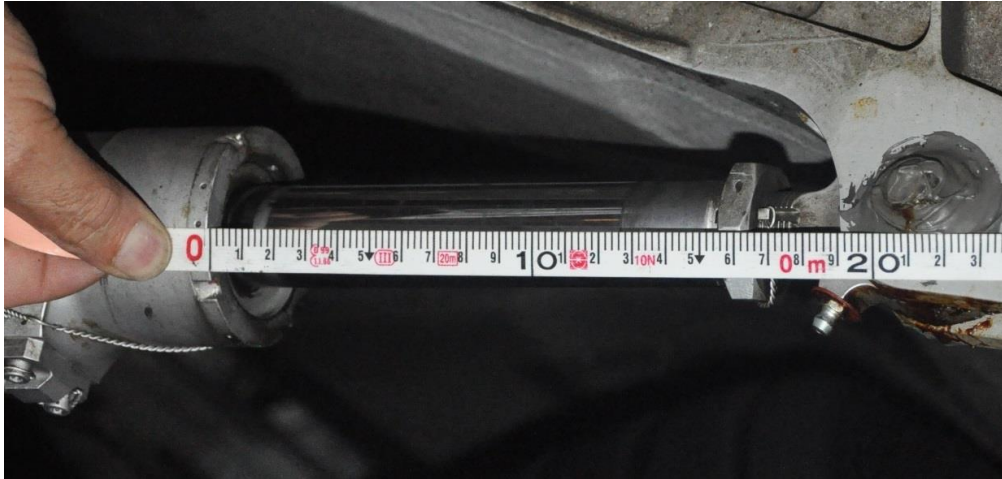
Foto 11: corsa attuatore in estensione.
