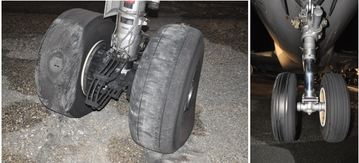
Foto 2: danneggiamenti al carrello principale sinistro ed a quello anteriore.
