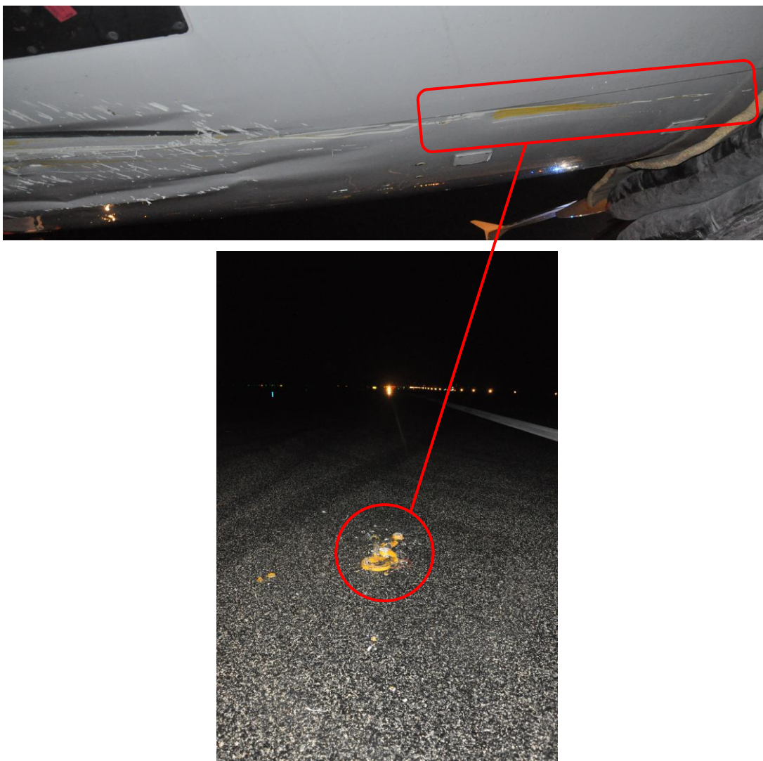
Foto 5: danni alla illuminazione laterale della pista e relativi segni sulla fusoliera posteriore del velivolo.
