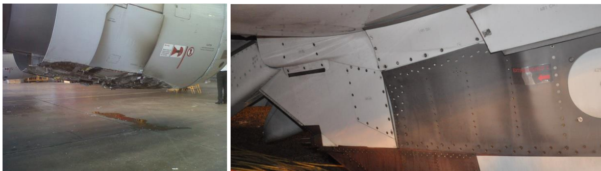
Foto 4: danneggiamenti motore destro e relativo pilone.
