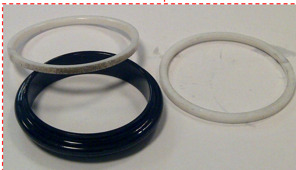
Foto 26: contaminazione trovata sul “LH MLG door actuator”.
