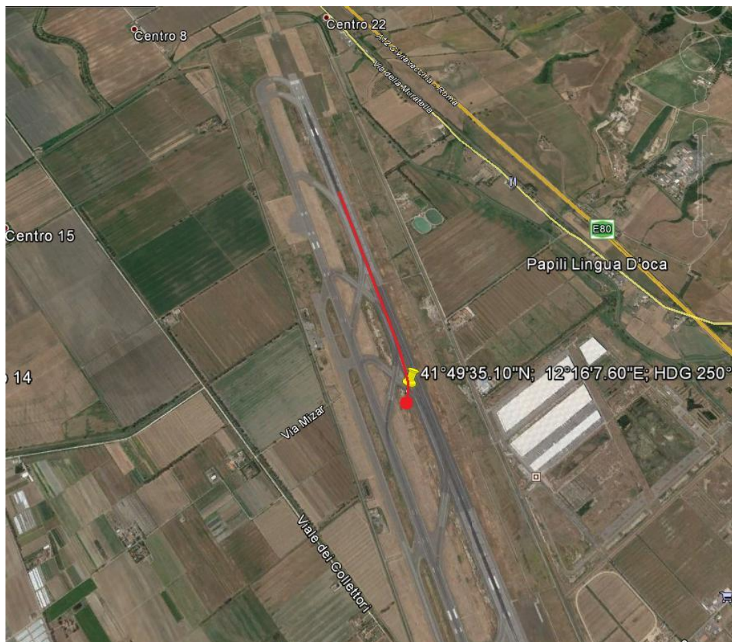
Figura 7: ricostruzione della toccata e corsa di atterraggio dell'EI-EIB.
