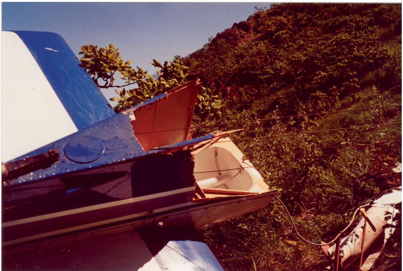
Resti velivolo impatto finale. Particolare piani di coda
