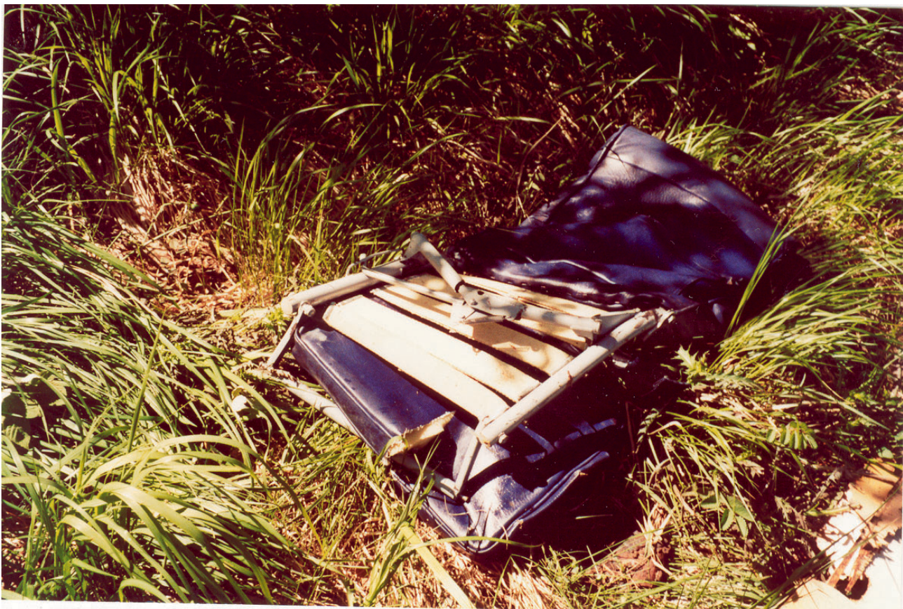
Particolare sedile passeggero sradicato completamente dall'alloggiamento in cabina
