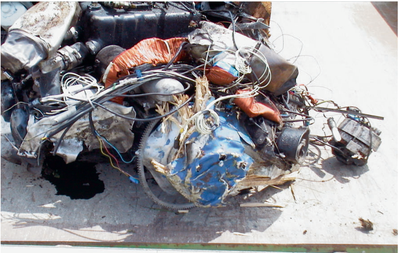
Particolare motore con mozzo elica. Notare le deformazioni del mozzo nel senso di rotazione dell'elica
