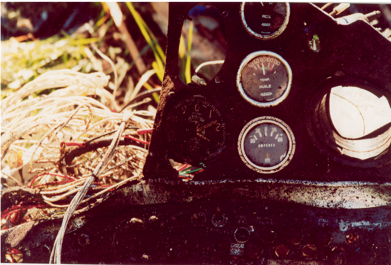
Resti velivolo. Particolare pannello strumenti. Notare indicazione altimetro compatibile con quota del punto di impatto
