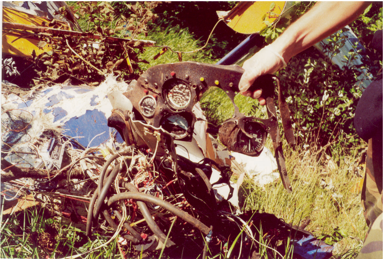
Resti velivolo. Particolare pannello strumenti
