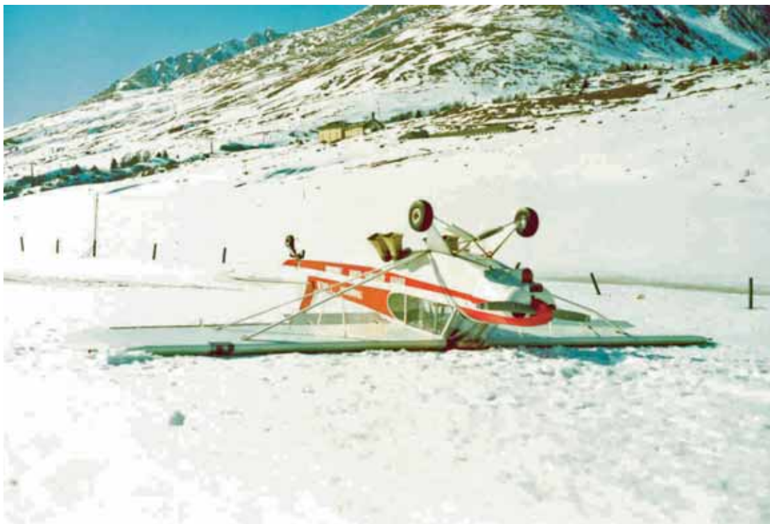
L'aeromobile fotografato dopo l'incidente. Visibili i danni riportati all'elica ed al montante della semiala destra.
