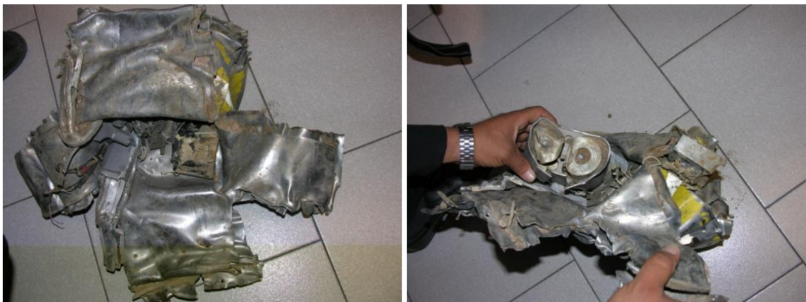
Foto 14 e 15: a sinistra, interno dell'involucro del FDR; a destra, posizionamento originario del foil record assembly .
