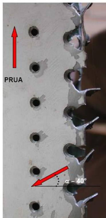
Figura 27 – Strappo fori pannello
