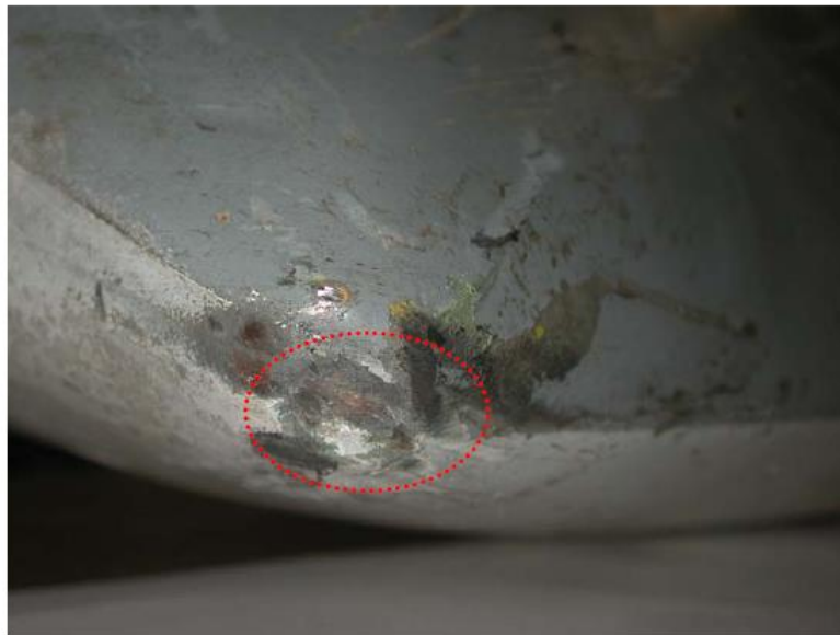
Figura 18 – Segno d'impatto superficie superiore massa equilibratrice
