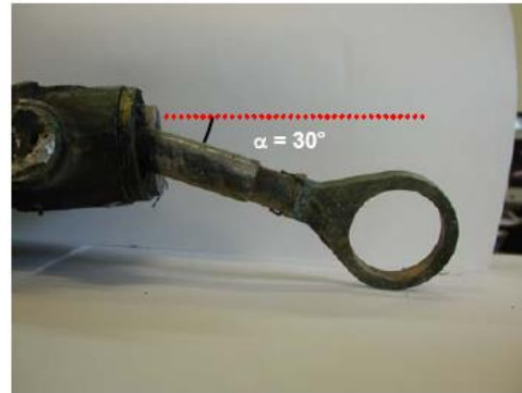
Figura 60 – Deformazione asta case n.2
