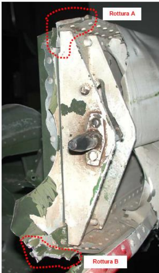
Figura 17 – rotture longherone timone
