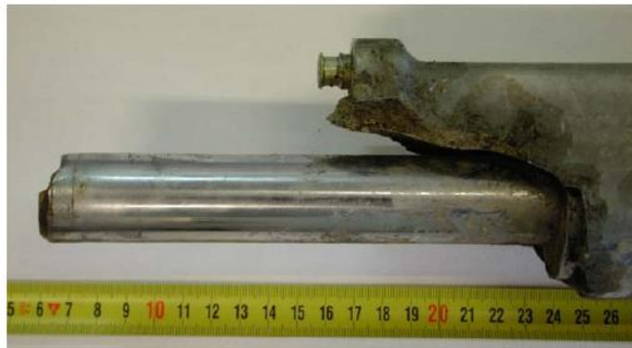
Figura 35 – Particolare rottura asta e case
