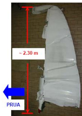
Figura 3 – parte del timone pervenuta
