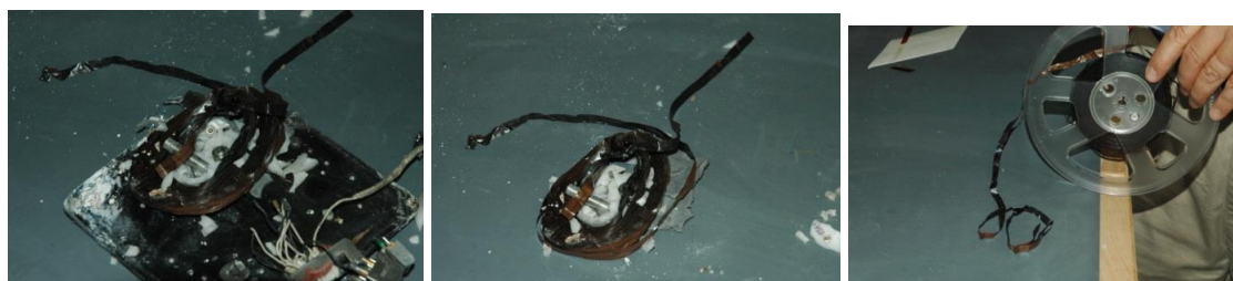
Foto 8, 9 e 10: a sinistra apertura contenitore del nastro; al centro, nastro; a destra, riavvolgimento del nastro CVR.
