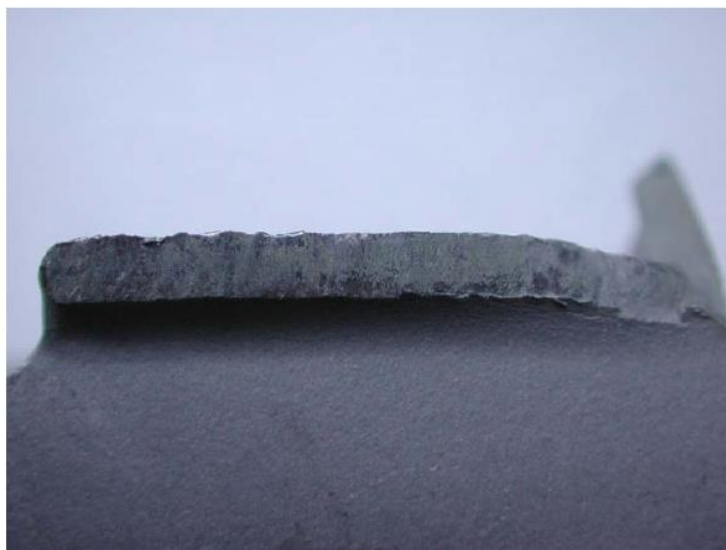
Figura 6 – Superficie di rottura curvatura raccordo
