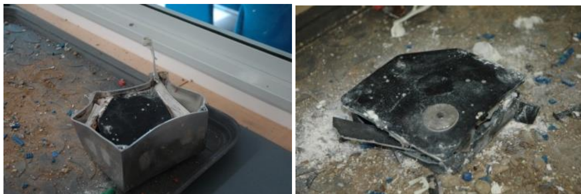
Foto 6 e 7: a sinistra, protezione del nastro CVR; a destra, contenitore nastro CVR.
